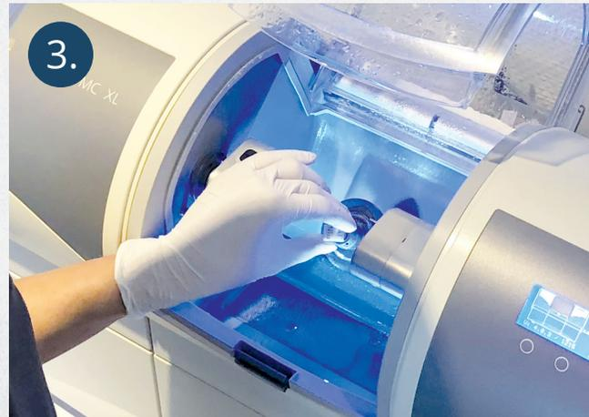
3. Die am Computer erstellte Restauration wird maschinell aus einem Keramikblock ausgeschliffen.
